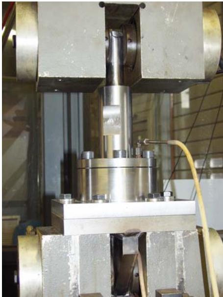
Bild 4.77: Aufbau und Versuchsbedingungen Riffeltest
