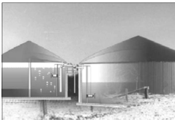
Abb. 3-7: Volldurchmischter Fermenter, Schnittdarstellung: Biogas Nord GmbH
