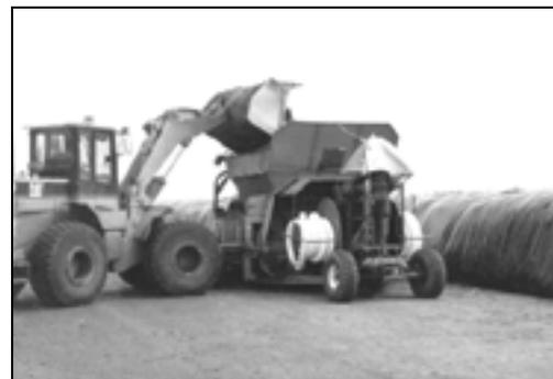
Abb. 3-11: Folienschlauchbefüllung; Foto: B. Linke, Institut für Agrartechnik Bornim
