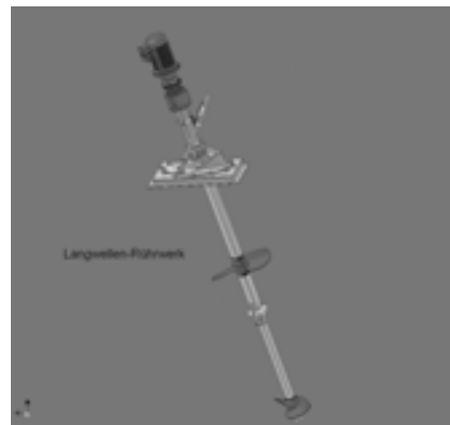
Abb. 3-37: Langachsührwerke mit zwei Rührwerkzeugen mit und ohne Lagerung am Fermenterboden;
