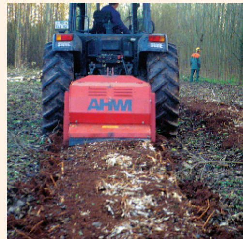
Abb. 11: Wurzelbeseitigung mit Forstfräse
