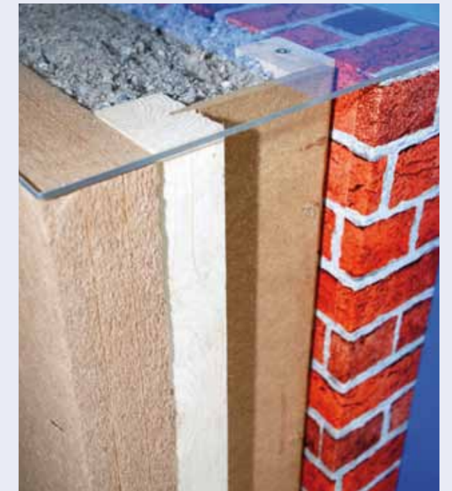
WDVS auf Mauerwerk mit Trägersystem
