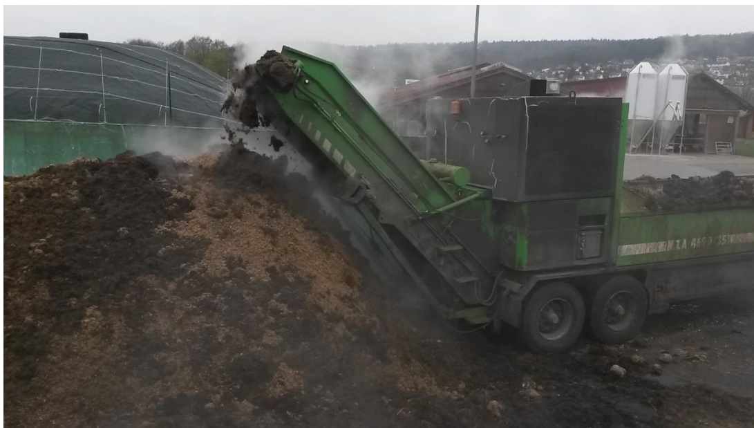
Abbildung 9: Zerkleinerung und Mischen von Rinderfestmist und Zuckerrübe
