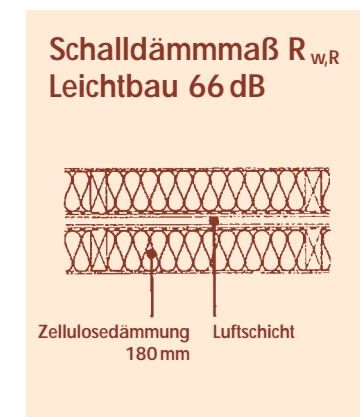
10 Schallschutz einer Haustrennwand (isofloc)
